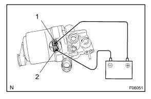
30. INSPECT BRAKE BOOSTER PUMP ASSY
