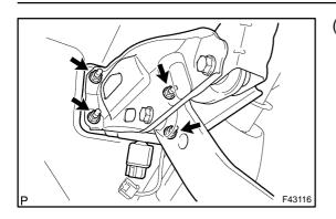
(d) Remove the 4 nuts and pull out the brake master cylinder.
